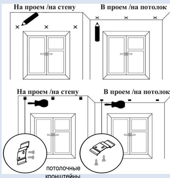
Рис. 6. Пример установки кассетных штор LVT
