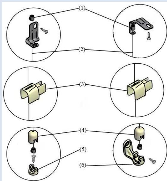
Рис. 5. Установка боковой фиксации
