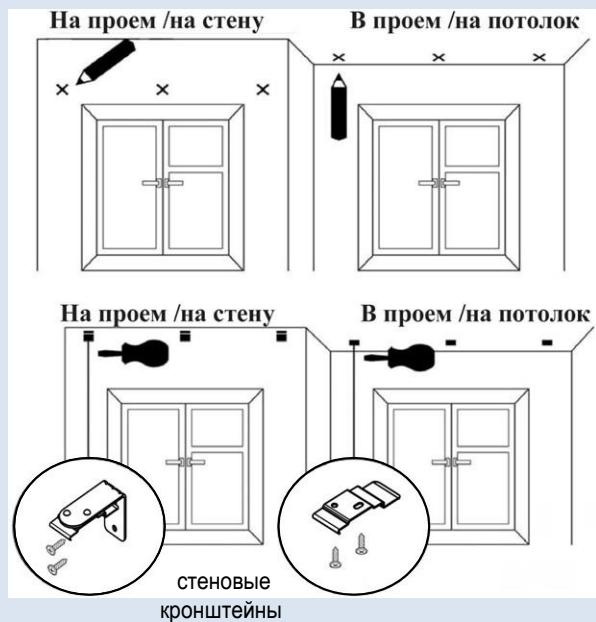
Рис. 7. Пример установки кассетных штор LVT на 3 кронштейна
